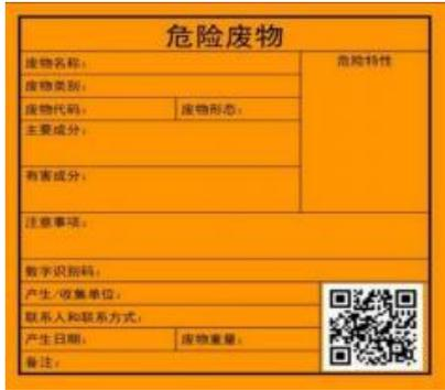
危险废物标签印刷的油墨应均匀，图案和文字应清晰、完整。危险废物标签的文字边缘宜加黑色边框，边框宽度不小于 1mm，边框外宜留不小于 3mm 的空白。
