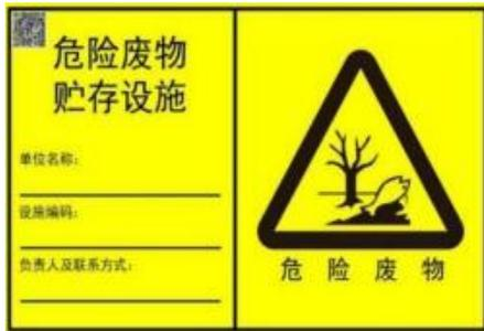
危险废物设施标志背景颜色为黄色，RGB 颜色值为（255，255，0）；字体和边框颜色为黑色，RGB 颜色值为（0，0，0）；危险废物设施标志字体应采用黑体字，其中危险废物设施类型的字样应加粗放大并居中显示。危险废物贮存设施标志宜采用坚固耐用的材料（如 1.5mm~2mm 冷轧钢板），并做搪瓷处理或贴膜处理。柱式标志牌的立柱可采用 38×4 无缝钢管或其他坚固耐用的材料，并经过防腐处理。三角形警告性图形与其他信息间宜加黑色分界线区分，分界线的宽度宜不小于 3mm。危险废物贮存设施标志可采用横版或竖版的形式。
