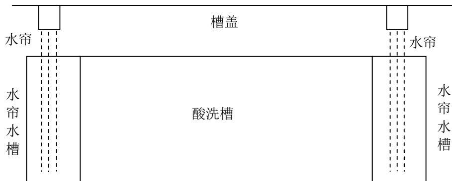
图 5 酸洗槽水帘示意图
